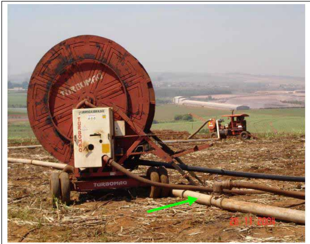
Fig 04 – Canon viajero (Hydro roll) para ferti-riego
